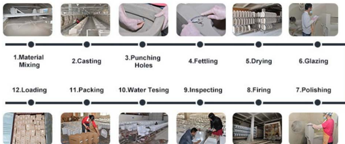
Figure 19 : Procédé de production de la céramique sanitaire (d'après l'audition de MIF, 2016)
